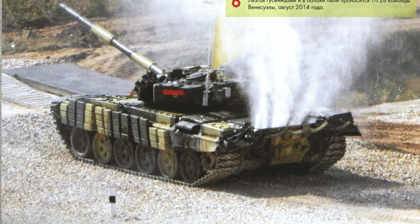
Финиш Т-72Б команды Анголы. Во время преодоления брода машина «зачерпнула» воды — вентилятор выбрасывает фонтан воды из жалюзи моторно-трансмиссионного отделения. Август 2014 года.
