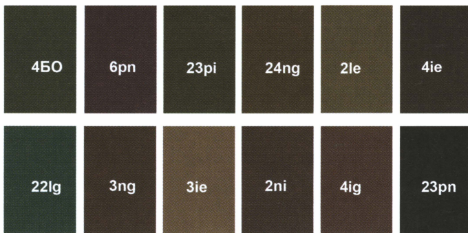
Образцы цветов, используемые при испытании деформирующих окрасок на НИБТ полигоне в августе 1939 года.
